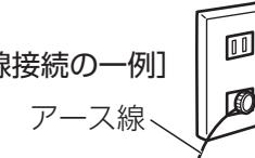
(アース工事がされていないとピリピリしたり漏電のときに感電する原因)
