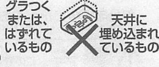
電気工事店(有資格者)に依頼して配線器具を交換してください。一般のかたの電源工事は禁止されています。
