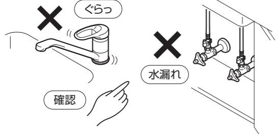
漏水を確認した場合は、止水栓または配管中の元栓を閉めてください。
