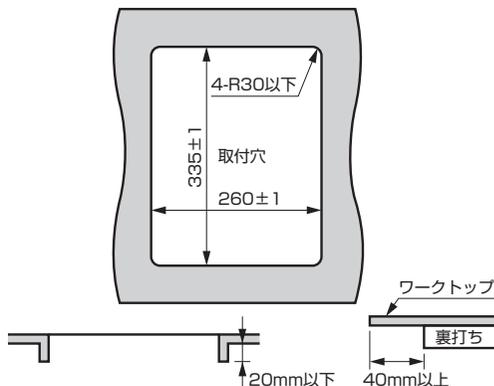
※260×335 (mm) の取付穴に取付ける場合、立上りをつけると本体が浮きます。取付穴周囲を補強する場合は立下りとし、高さを20mm以下にしてください。
